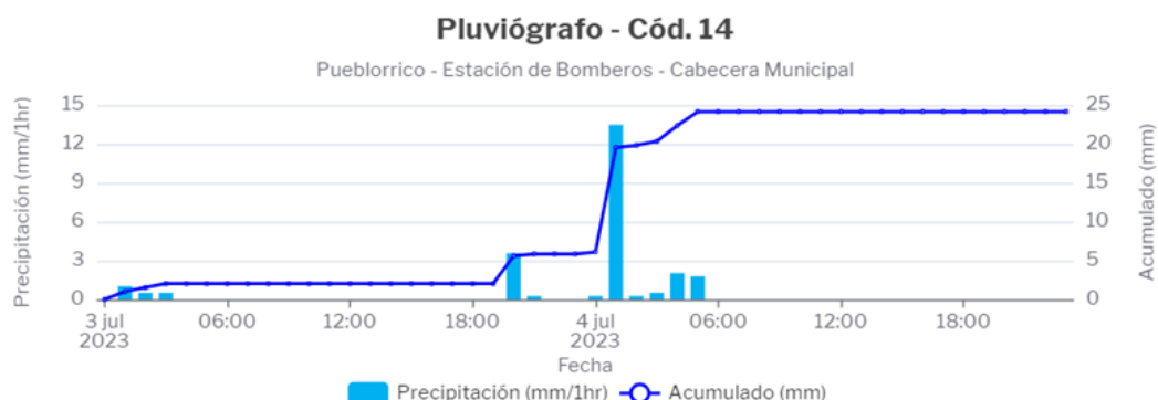
Figura 44. Evento de precipitación registrado en la estación pluviográfica con código 14 de la red PIRAGUA, estación de bomberos en la cabecera municipal de Pueblorrico.
