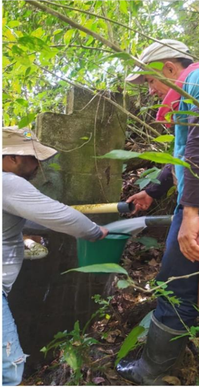
Fotografía 1. Aforo en captación de agua
