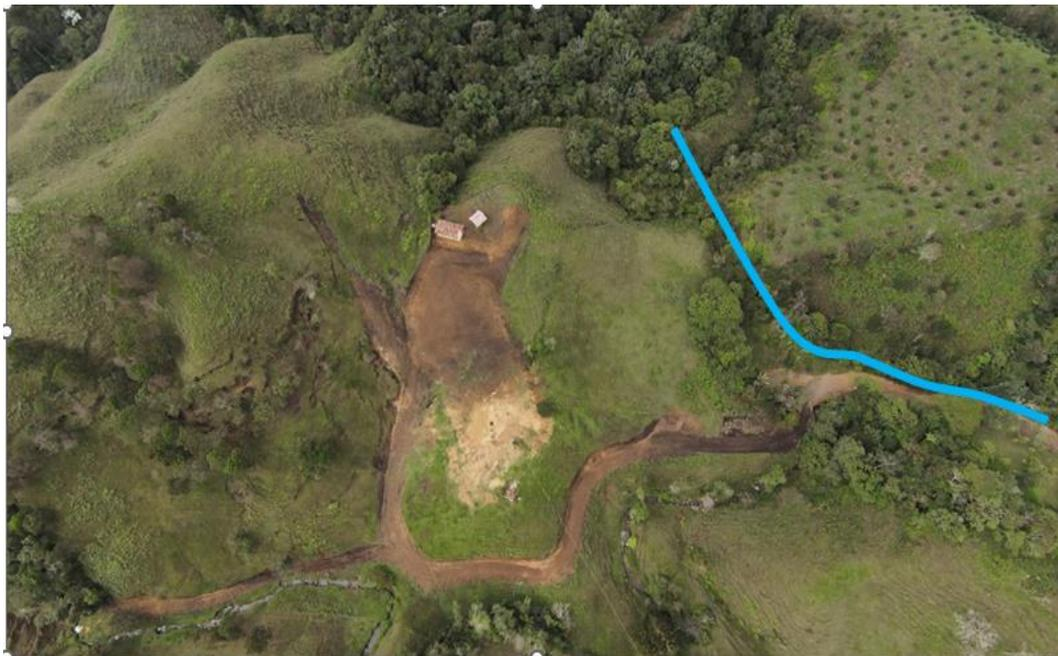
**Fotografía 10. Explanación y apertura de vía sobre el retiro de la fuente La Sola.**
