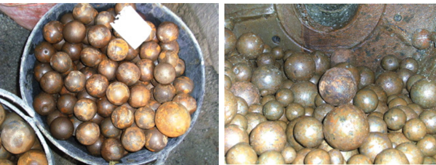
Figura 2. Carga adecuada de medios molidores.
