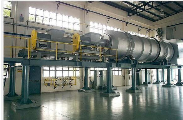
Los incineradores de horno rotatorio cuentan con cámaras cilíndricas recubiertas de refractarios, que cuentan con una leve inclinación horizontal y rotan a una velocidad. Este diseño permite que los residuos que ingresan por un extremo se desplacen mezclándose a través del horno, hasta ser descargados en el otro extremo. Cuentan con un quemador, ubicado del lado de la alimentación, que utiliza combustibles o residuos líquidos de alto poder calorífico.
