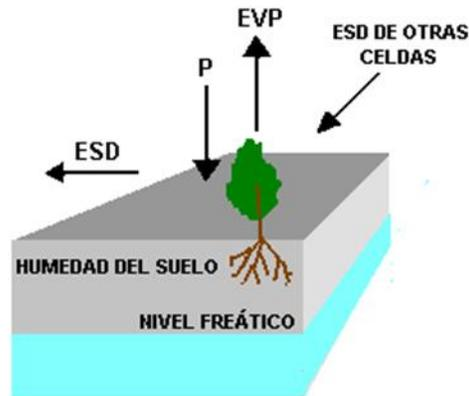
**Figura 24.** Balance hídrico en una celda (P: precipitación; EVP: evapotranspiración; ESD: escorrentía)
